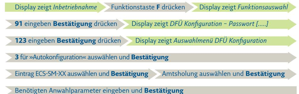
⚠ Modemspezifische Zeichen (z.B. »W« = warten auf Wählton) können bei der Abfrage mit der \*Taste wie folgt eingefügt werden: \*Taste eingeben; Gewünschtes modemspezifisches Zeichen mit **↑** auswählen und mit Bestätigung übernehmen; Mit der \*Taste kann die Auswahl wieder verlassen werden.
