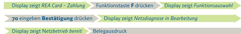
Erscheint auf dem Display und dem Beleg der Text *Netzbetrieb bereit*, so ist die Verbindung zum Abrechnungssystem in Ordnung. Andernfalls ist die Netzverbindung gestört. Wenden Sie sich unter Angabe der Terminal-ID und der Fehlernummer auf dem Beleg an Ihre Hotline.
