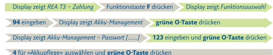
Durch einen erneuten Druck auf die grüne O-Taste (Bestätigungs-taste) starten Sie die Akkupflege. Denken Sie daran, dass die Akkupflege mehrere Stunden dauert, in denen Sie das Gerät nicht verwenden können.
